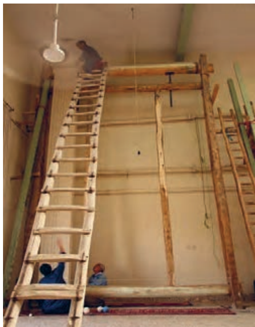
شکل ۲۱-۱ دار ثابت چوبی برای بافت قالی و گلیم
