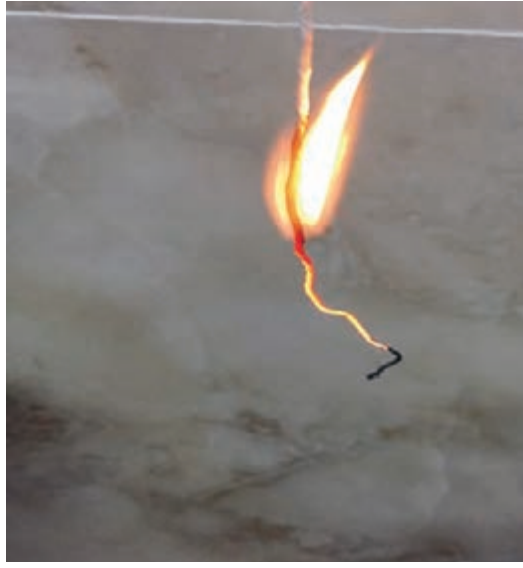
شکل ۱۳-۱ سوختن نخ پنبه‌ای
