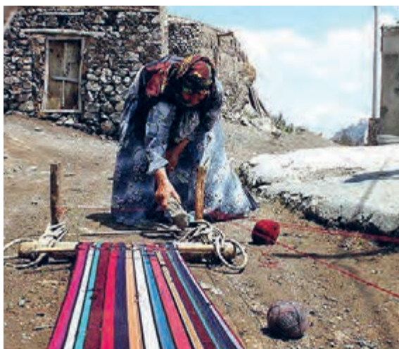
شکل ۳۶-۱ دستگاه چوبی جاجیم بافی (افقی)
