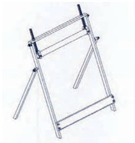
شکل ۲۶-۱ فندک دار لولایی (زاویه دار)
