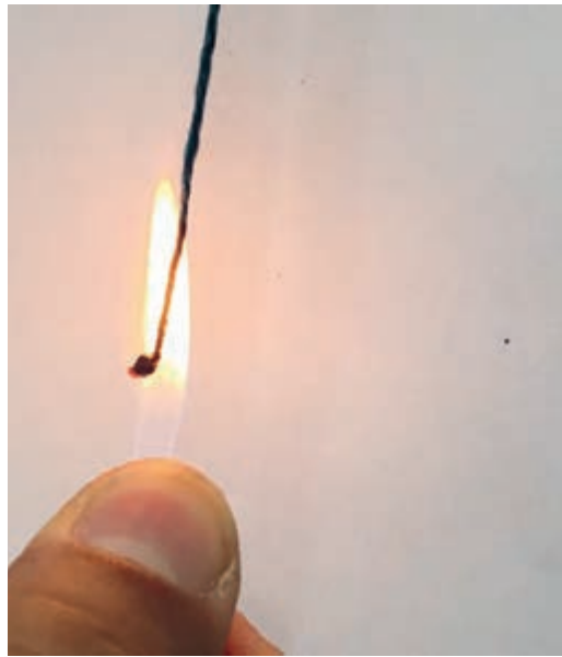
شکل ۱۴-۱ سوختن نخ مصنوعی
