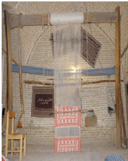
شکل ۲۲-۱ دار چوبی و ثابت برای بافت زیلو
